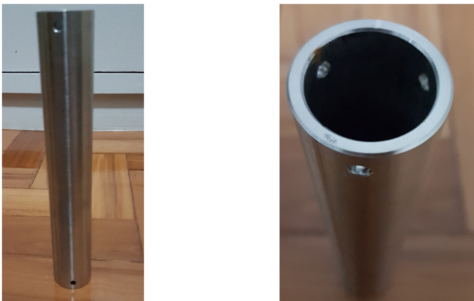
Figura 25. Câmara de combustão.
